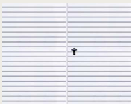
Brama rozwierna dwuskrzydłowa wypełniona blachą T-10, układ wypełnienia poziomy
